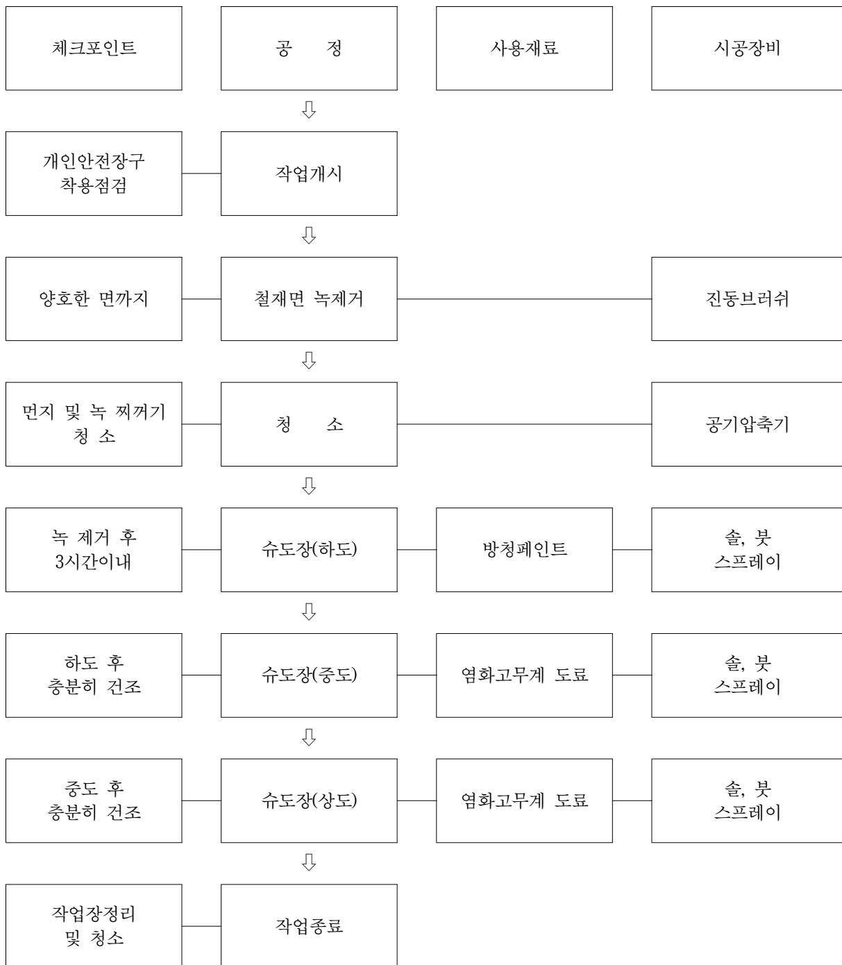
【그림 7.7】 교량받침 도장보수 시공흐름도
